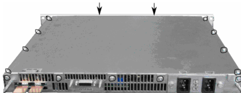
Рисунок 4.1 – Вид изделия с тыльной стороны. Указание крепёжных винтов.
