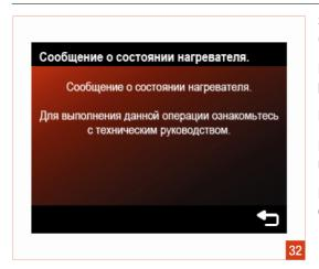
Это сообщение означает, что нагреватель более не функционирует. (см. рисунок 32)
