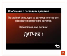
Это сообщение означает, что один или несколько датчиков CO2 или датчиков присутствия более не регистрируются системой. Система показывает номер(а) соответствующего(их) датчика(ов). (см. рисунок 31)
