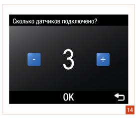
Этот этап нужен для проверки подключенных кабелями RJ12 к системе DXR датчиков концентрации CO2 или датчиков присутствия. см. рисунок 14.
