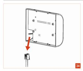
Панель управления получает питание непосредственно от блока системы DXR. Чтобы отключить панель управления от сети, отсоедините кабель RJ12 от порта на задней части корпуса. (см. рисунок 34).
