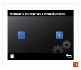
1. Чтобы указать заданную температуру: Нажмите «Расширенные настройки». Нажмите «Определить заданную температуру» См. рисунок 19.
