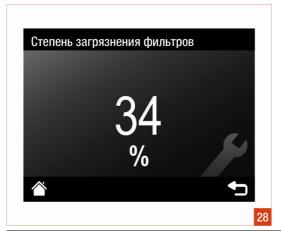
Степень загрязнения фильтров можно узнать, нажав на название соответствующего параметра в меню «Техническое обслуживание». На экране появятся данные о степени загрязнения фильтров, выявленной при последней проверке.
