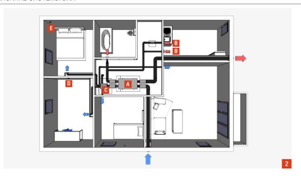
DXR представляет собой автоматически регулируемую приточно-вытяжную систему вентиляции с рекуперацией тепла. Данная система может использоваться в квартире, частном доме, офисном помещении, гостинице и т.д., если требуемый расход воздуха соответствует воздухообмену, обеспечиваемому системой.
