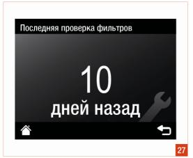
Дату последней проверки фильтров можно узнать, нажав на название соответствующего параметра в меню «Техническое обслуживание». Текущее значение параметра появится на экране (см. рисунок 27)
