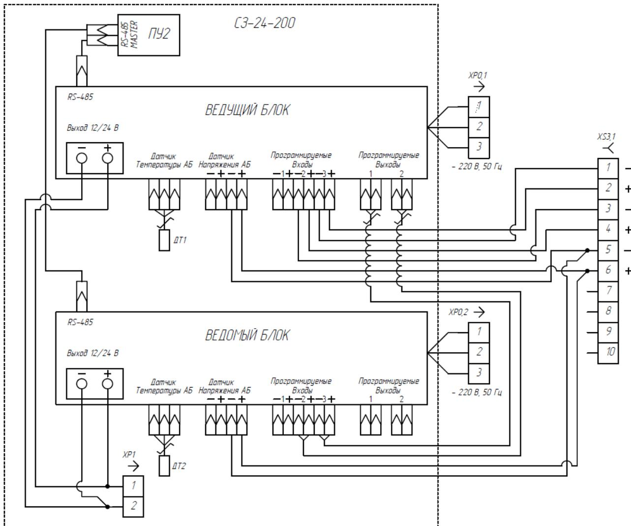
Рисунок 3 – Схема соединения ЗУ в составе станции
