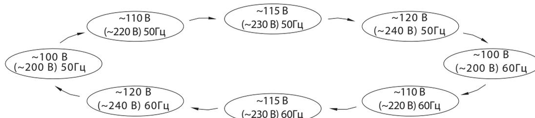
Рисунок 5.2: Диаграмма последовательности выбора выходного напряжения и частоты
