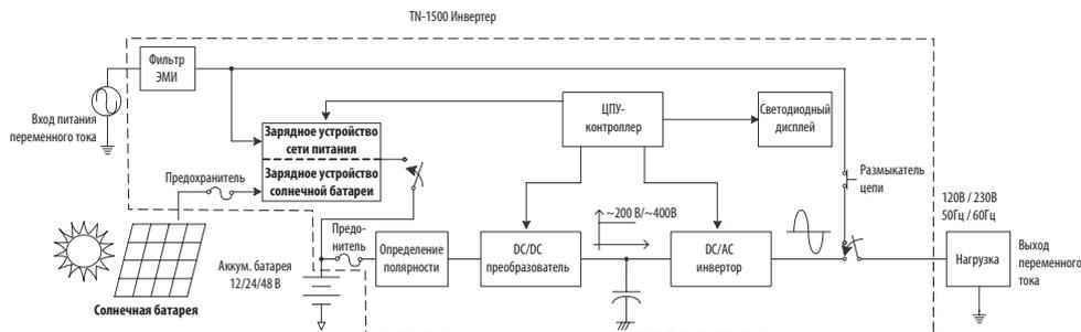
Рисунок 2.1 Структурная схема системы
