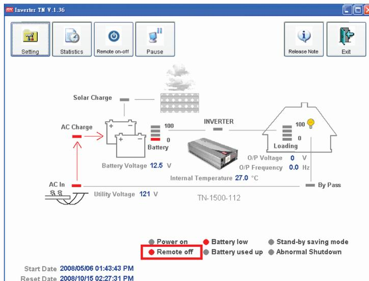
Чтобы включить питание инвертора, выберите значок Remote on-off, питание инвертора будет включено после звукового сигнала. Индикация «Remote off» изменится на «Remote on», что подтверждает состояние включения питания.
