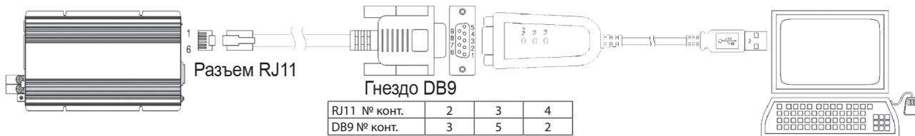
Если для соединения инвертора и компьютера используется преобразователь MOXA, перед подключением кабеля в разъем USB ПК необходимо сначала включить питание компьютера, в противном случае, соединение не будет установлено.
