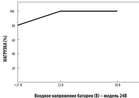
Рисунок 7.3: Зависимость выходной мощности от входного напряжения
