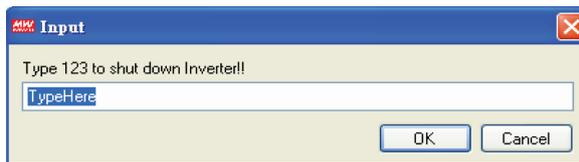
Вместо «TypeHere» введите «123», нажмите кнопку ОК, питание инвертора будет выключено после звукового сигнала. Индикация «Remote ON» на экране меню контроля изменится на «Remote OFF», что подтверждает выключение питания. См. рисунок.
